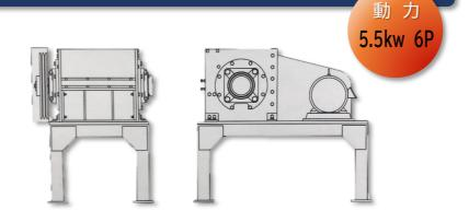
■搬送能力 135kg/h (PET0.2mm φ6) ■動力 5.5kw 6P ■主要寸法 W800×L1000×H1000 ■回転刃4枚/固定刃2枚
